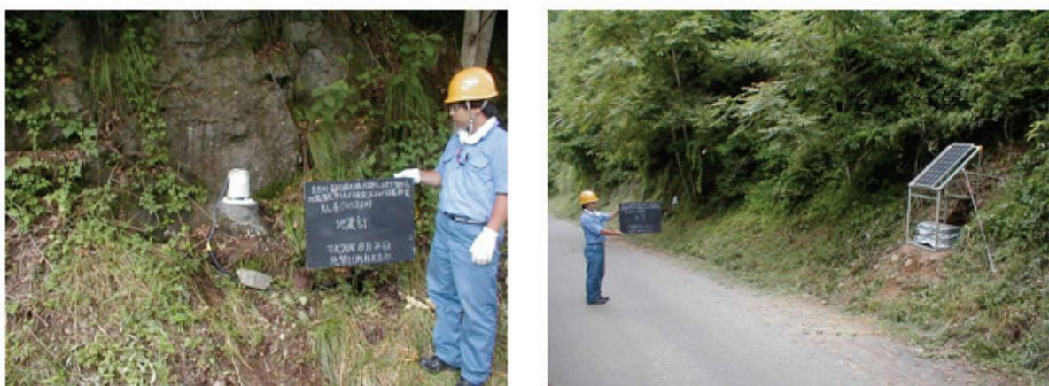
図 2 臨時観測風景。地震計は岩盤の上に固定した。
