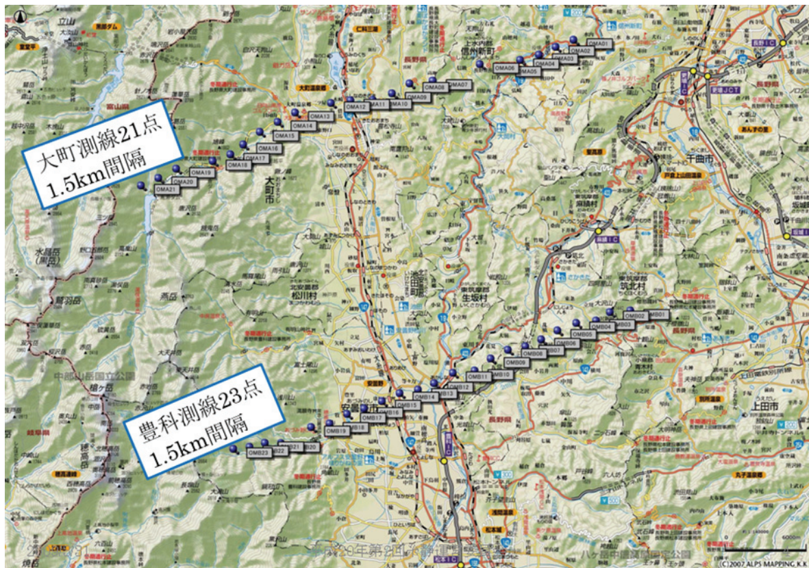
図1 平成20年度に実施した稠密自然地震観測点（青色●印44点）の配置図。大町測線内の地震計設置間隔は1.5 kmで計21点から構成され、豊科測線内の地震計設置間隔も1.5 kmで計23点から構成される。
