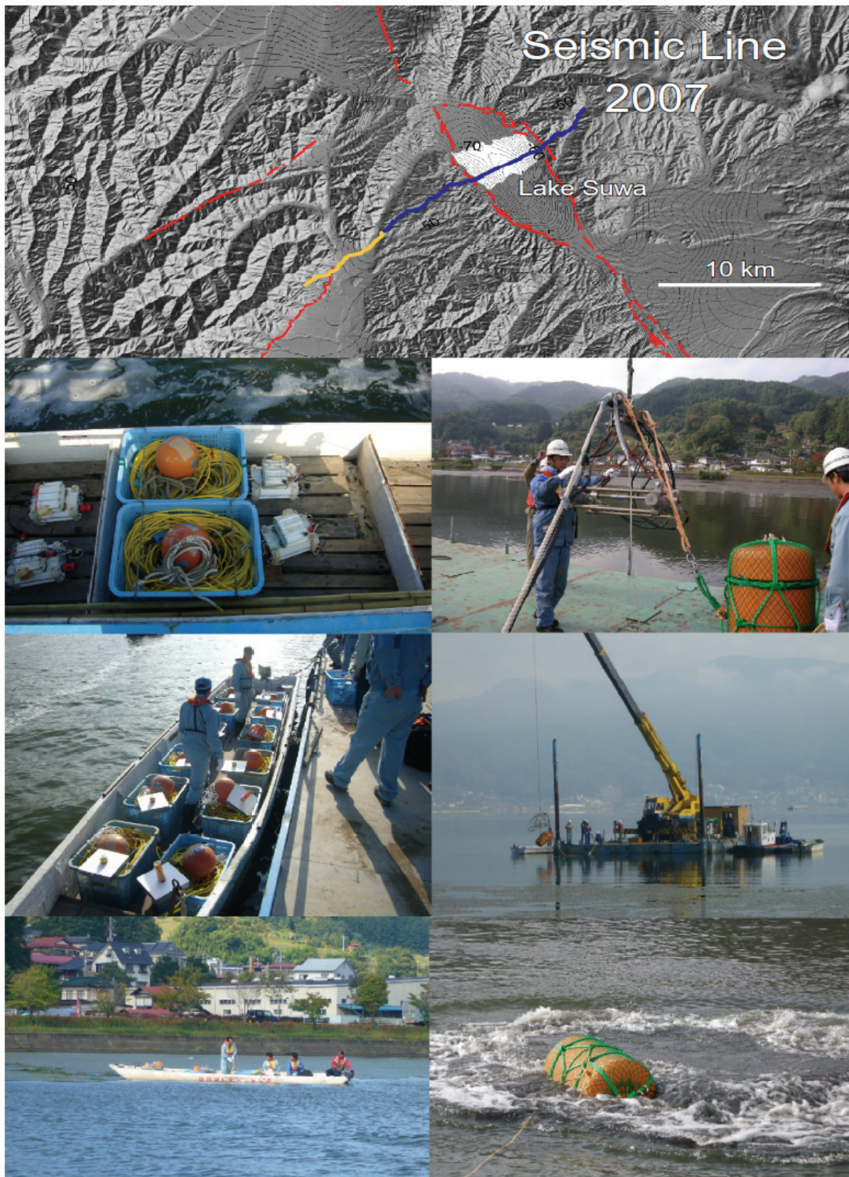
諏訪湖を横断する地震探査観測。 上図は探査側線。 その下6枚の写真は、バイケーブルの敷設と湖上でのエアガン発震作業。
