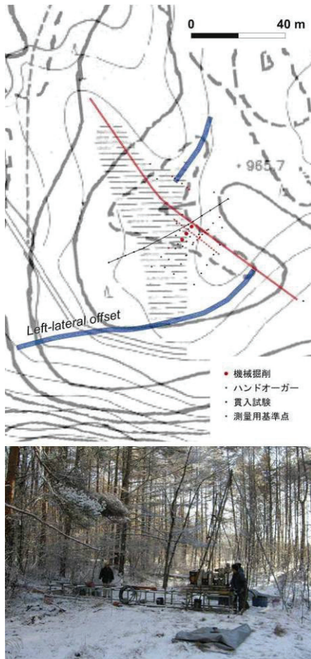
図5 試錐調査概要 地図中の赤線は活断層線
