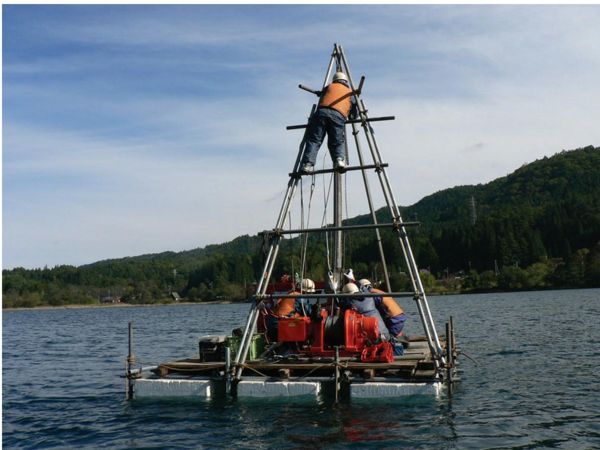
写真1 フロート台船による青木湖でのピストンコアリング状況
