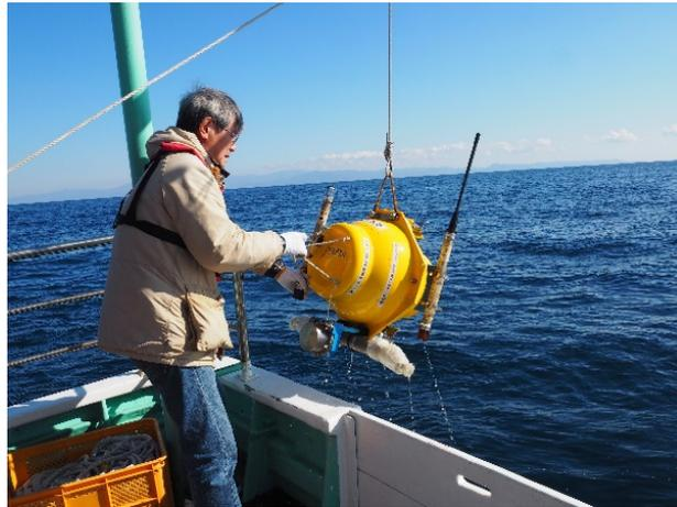
図 自己浮上式海底地震計（OBS）回収の様子
