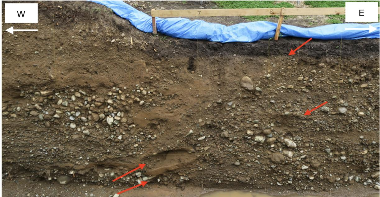
図 5 富士宮市上柚野で行ったトレンチ調査で出現した露頭。赤矢印は断層の可能性のある地層境界。北壁面を示す。
