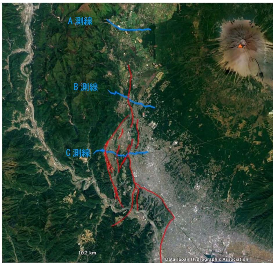
図 反射法地震探査の測線図。赤線は活断層の位置（中田・今泉編, 2002）を示す。
