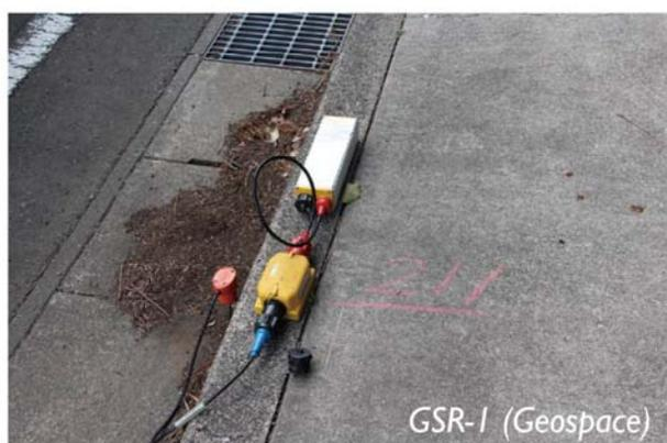
図 C 測線での観測風景。(上) 震源車 2 台による発振。(下) 敷設された独立型地震波形収録器。
