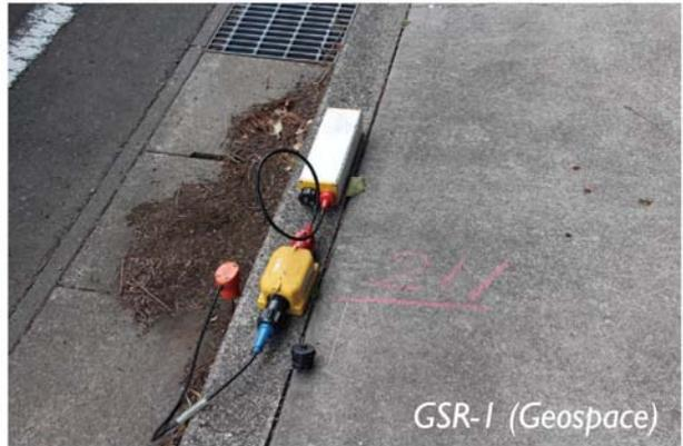
図 2 C 測線での観測風景。(左) 震源車 2 台による発振。(右) 敷設された独立型地震波形収録器。
