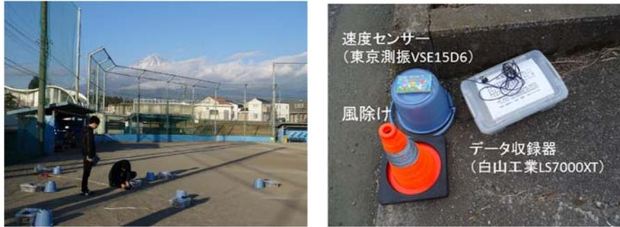
図7 本研究による微動アレイ観測の様子（左）と観測機器（右）。
