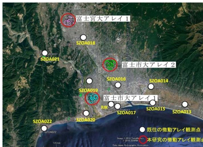
図 6 本研究による微動探査（赤丸）と既往の研究による微動探査（白丸）の位置。
