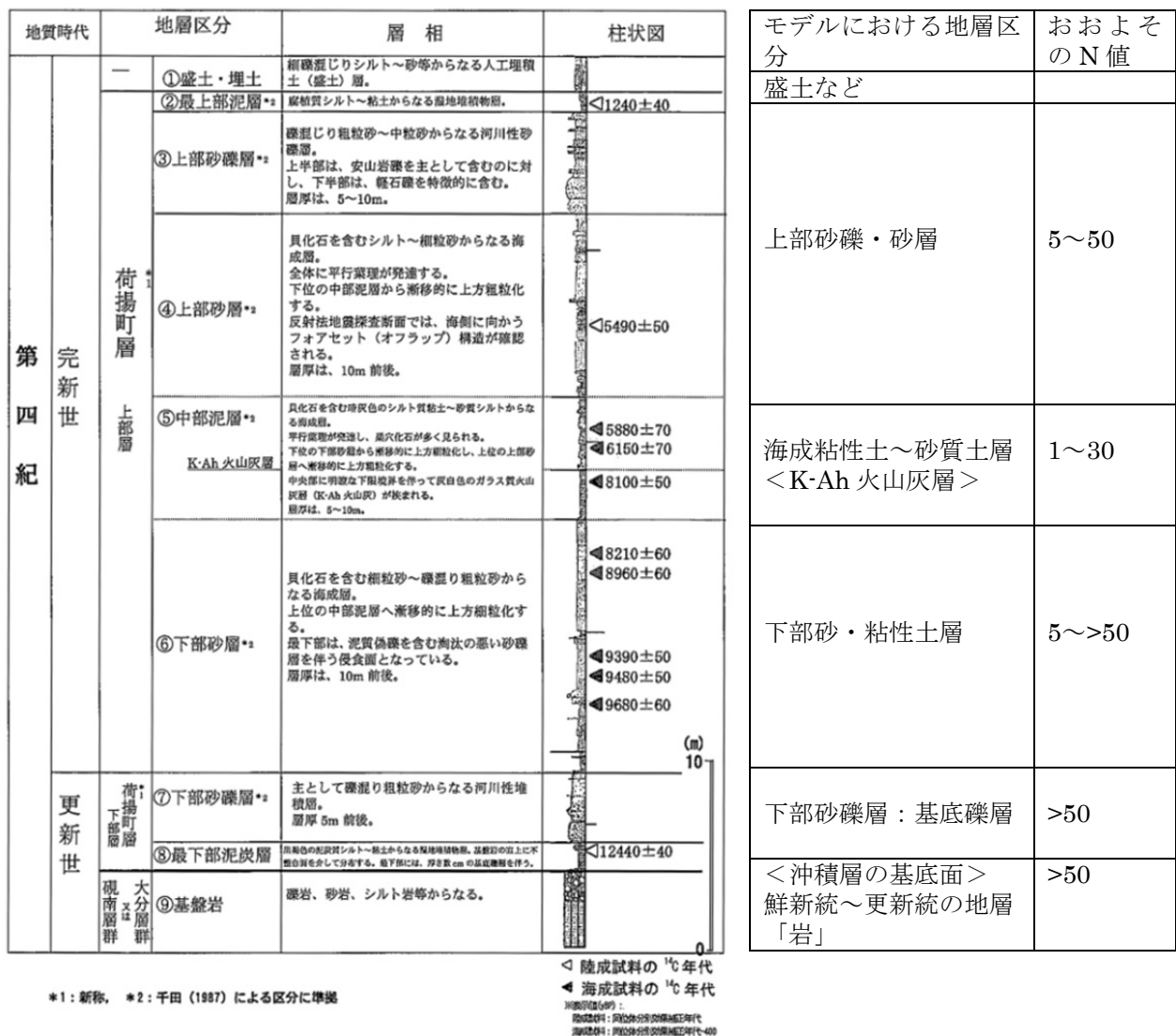
図 3.3.5-7 大分平野の沖積層の模式層序・モデル化における層区分（大分県，2001）
