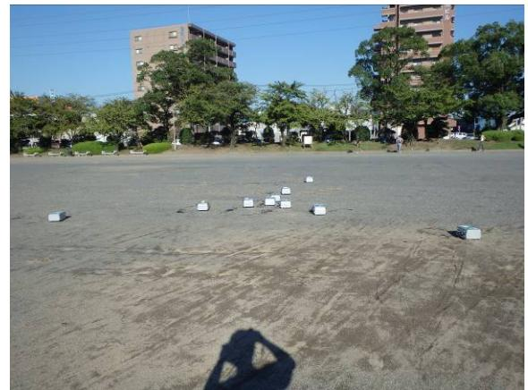
写真3.3.2-44 小さい半径の小半径アレイ微動観測の観測風景（半径4.5m、1.5m、0.5m）(平和市民公園多目的広場)
