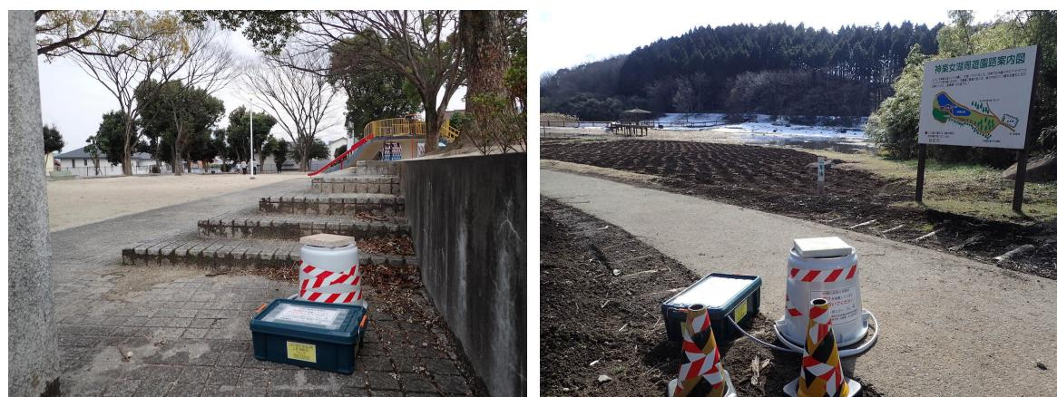
写真 3.3.2-46 単点微動観測の様子（左：別府市内、右：神楽女湖）（速度計はバケツ内、ロガー等はプラスチックケース内に格納）
