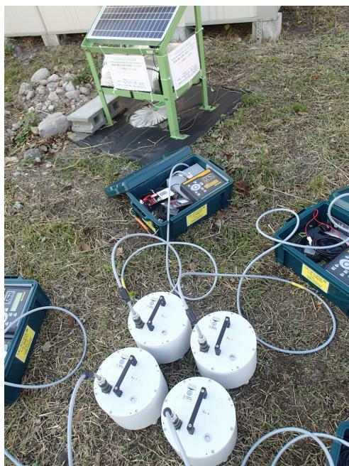
写真 3.3.2-45 導入した固有周期 20 秒の 3 成分速度計（LE-3D/30s）とデータロガー
