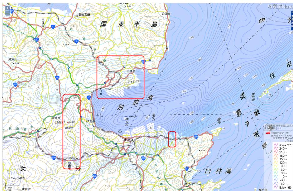
図3.3.2-7 別府湾周辺の重力異常分布（仮定密度  $2.67 \text{ g/cm}^3$ ：産業技術総合研究所）と単点微動観測の対象地域（庄内-別府、日出-杵築、坂ノ市）（基図は地質図 NAVI）
