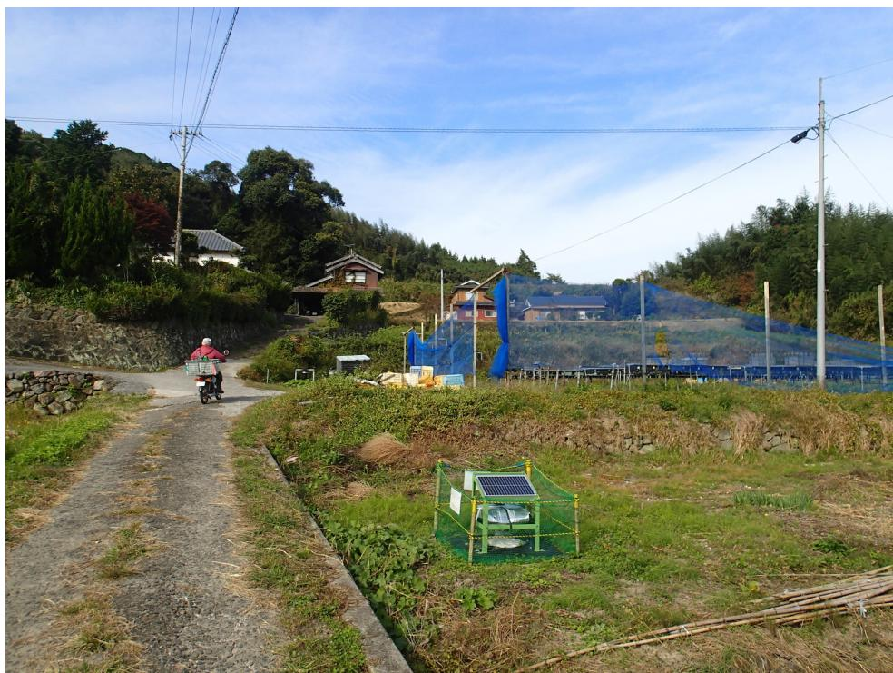
写真 3.3.3-1 連続微動観測装置の設置状況（BEP01 地点）
