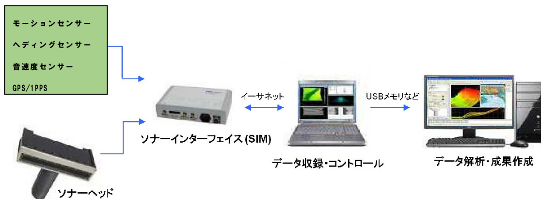
図13 ナローマルチビーム測深システム(データ収録)
