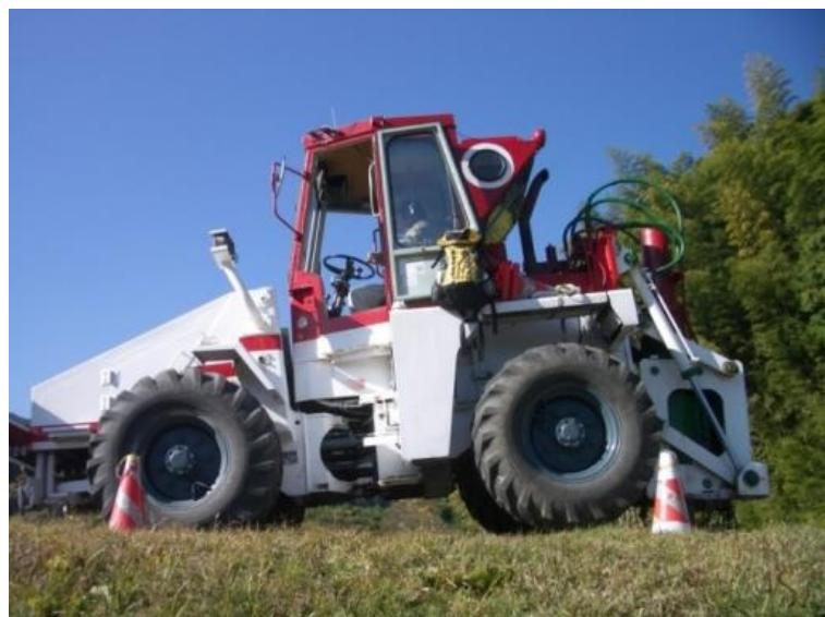
図 128 中型油圧インパクター震源
