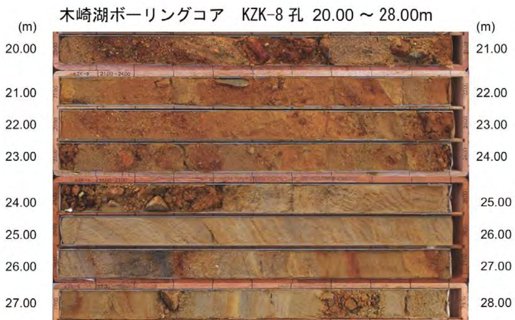
図 21 KZK-8 孔のボーリングコア写真（続き）。掘削位置は図 17 に示す。
