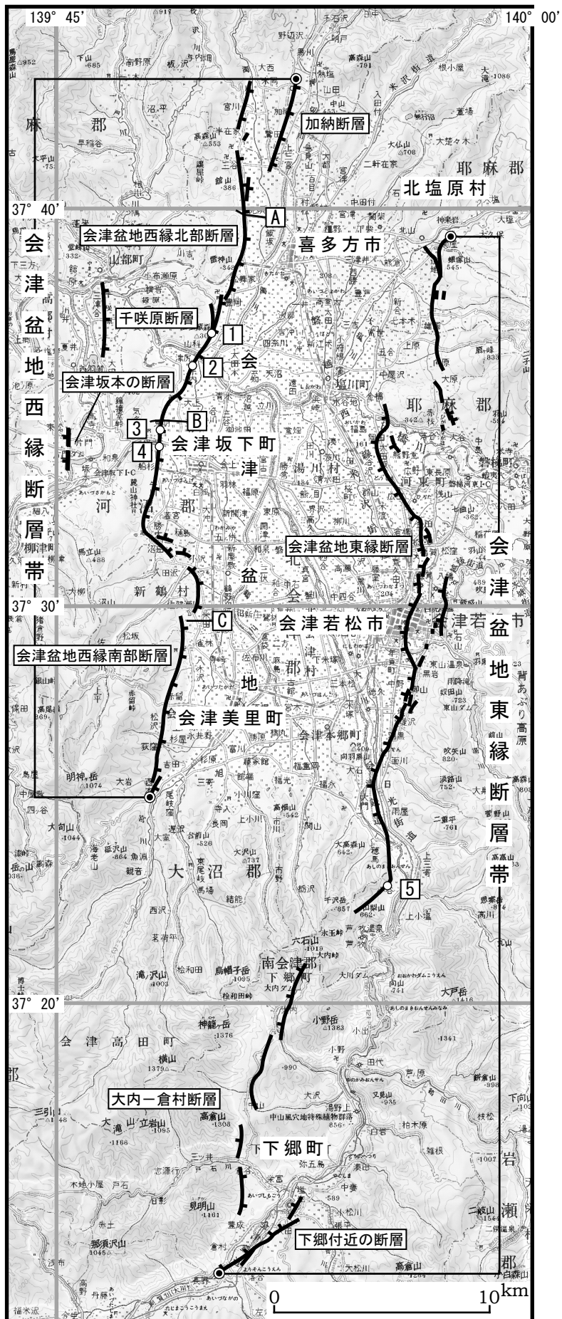
図2 会津盆地西縁・東縁断層帯の位置と主な調査地点 1：新宮地点 2：大川地点 3：見明地点 4：塔寺地点 5：小谷地点 A-C：反射法弾性波探査測線（文献2） ◎：断層帯の北端と南端 断層の位置は文献5，6，8，9，10及び12に基づく。 基図は国土地理院発行数値地図200000「新潟」を使用。
