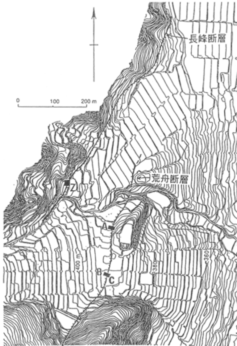
図9 荒舟地域の地形と断層の分布 (佃ほか, 1995) AとBはトレンチ調査地, Zは断層露頭を示す.
