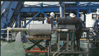
海底ケーシング設置型コアラ投入準備
