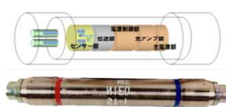
ケーブル式海底観測装置 (地震計・水圧計)
