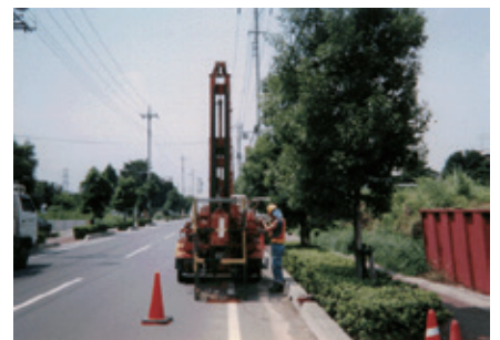
人工的に地面を揺らして、地下の構造を調査（埼玉県） 写真提供：埼玉県
