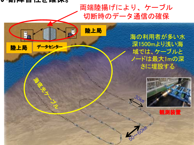
陸上局: 観測装置への給電と観測装置からのデータ受信・フィルタリング等の処理・データ配信を行う。 データセンター: 各陸上局からのデータを集信し処理・蓄積を行う。
