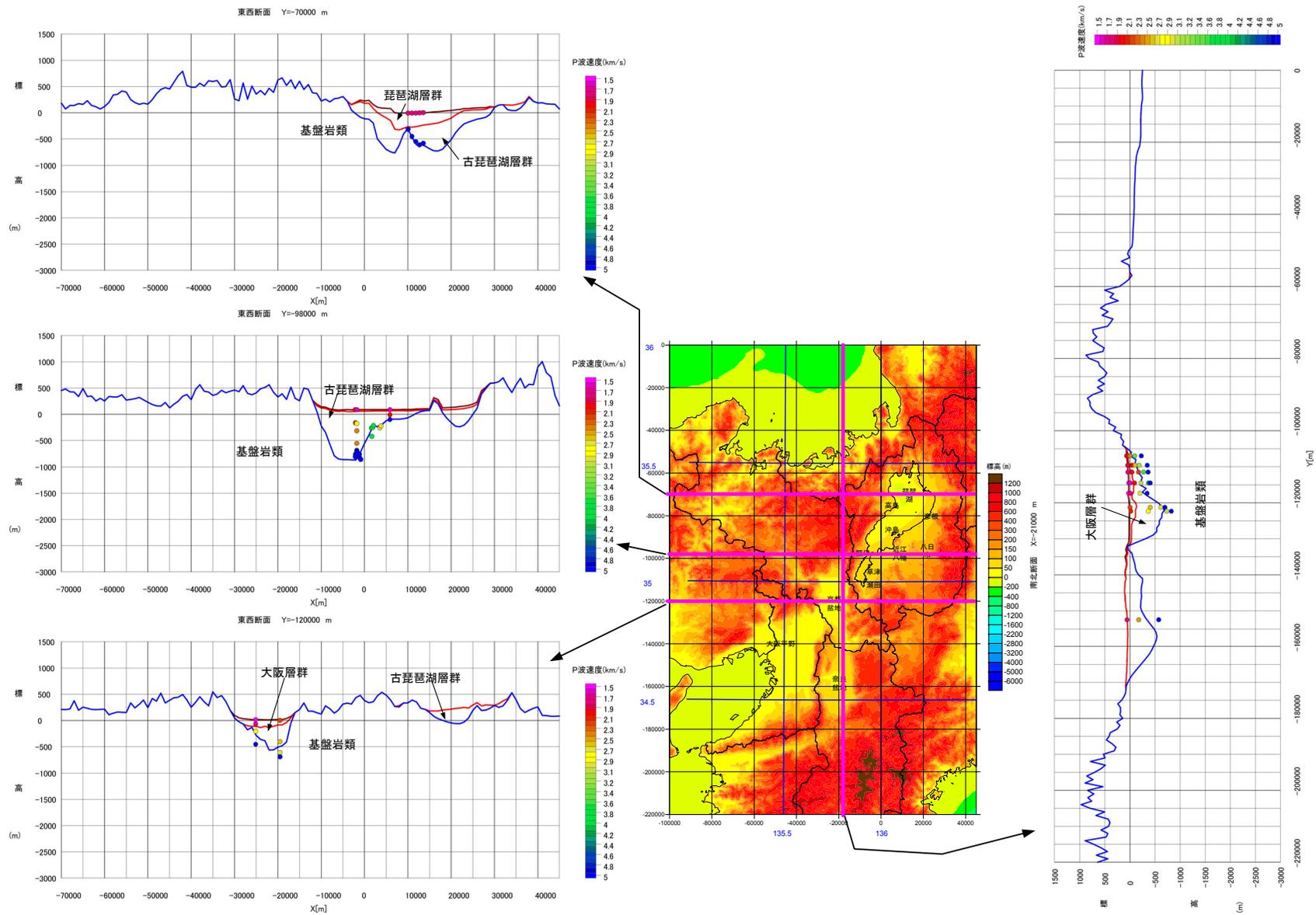
図13 地質断面図と物理探査データ
