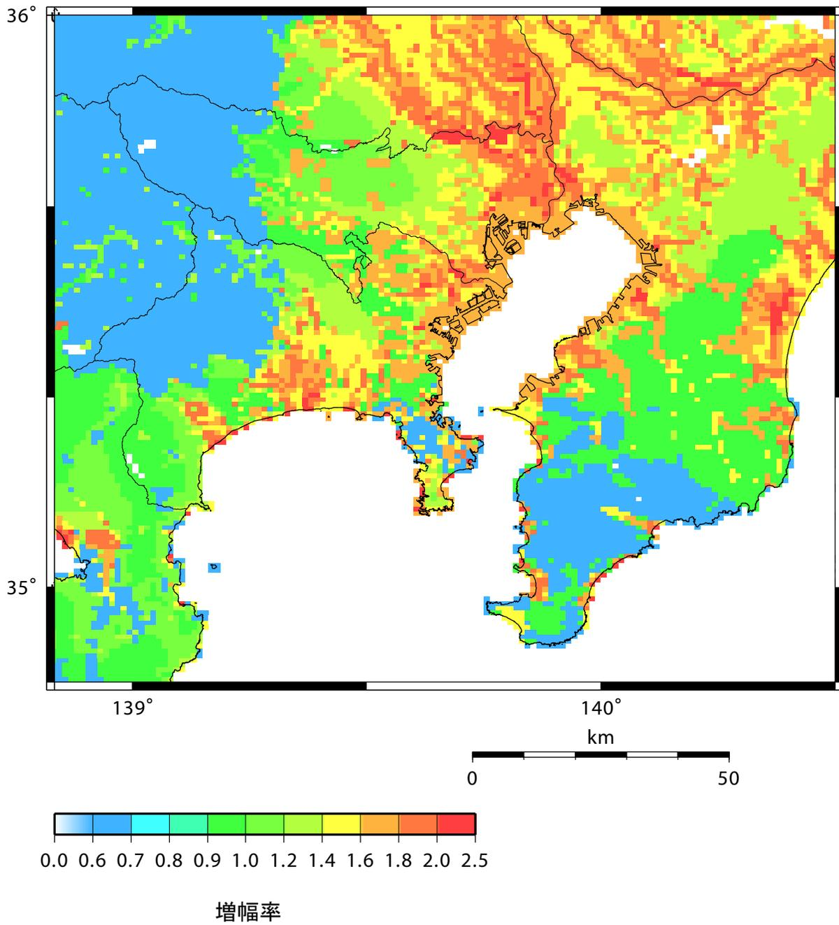
図4 工学的基盤 ( $V_s=400\text{m/s}$ ) から地表までの最大速度の増幅率 (浅い地盤構造)
