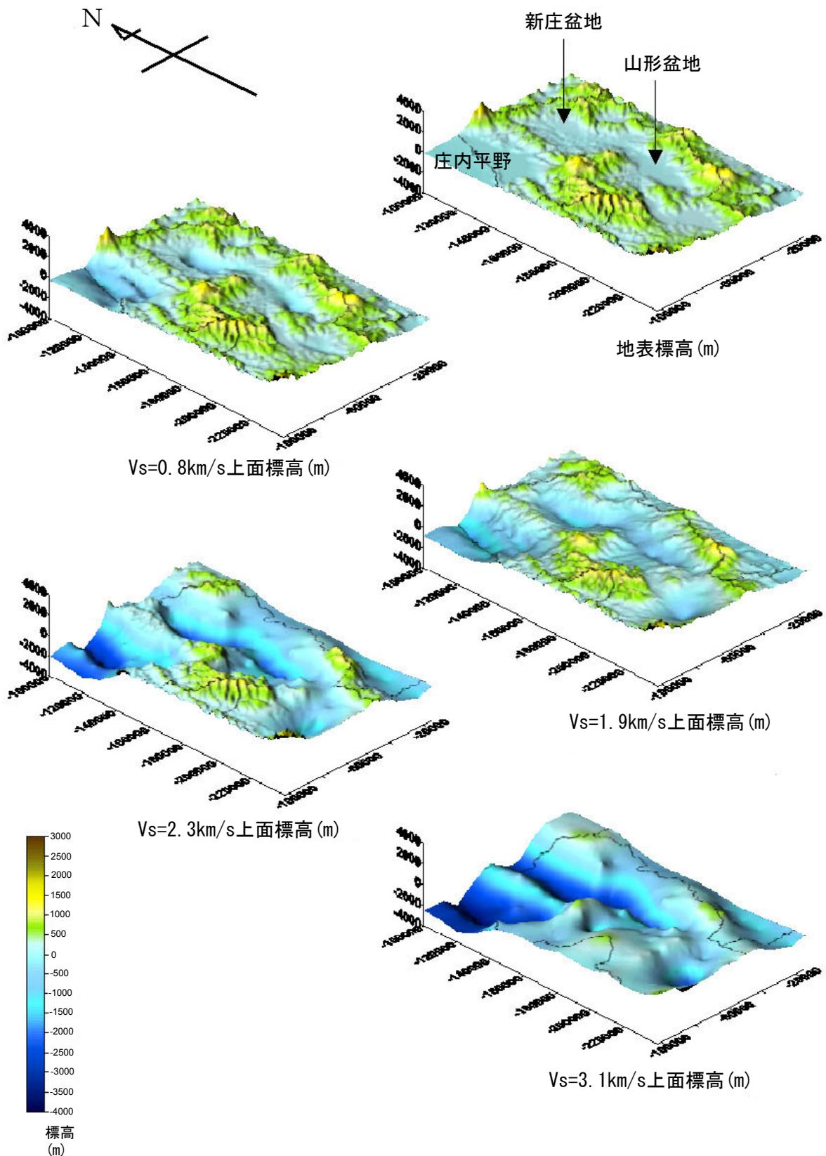
図3 深い地盤構造モデル
