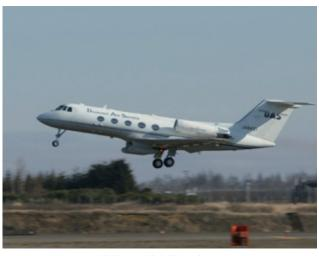
図2 Pi-SAR2 を搭載した航空機 (ガルフストリーム II)。翼下の2つのポッドの中にアンテナを収容。2つのアンテナで取得するデータの位相差は視差に起因することから、表面の起伏(高さ)を計測できる。
