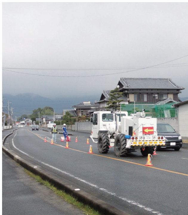
図3 佐賀平野北縁断層帯における反射法地震探査の作業状況(丸山正氏撮影)
