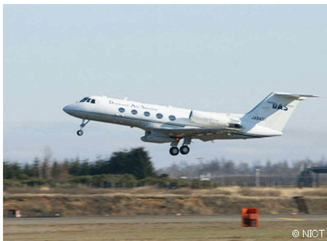
図2 Pi-SAR2を搭載した航空機。主翼の付け根にアンテナ部を装着している。左右のアンテナを用いたインターフェロメトリ機能による3次元データを取得する。
