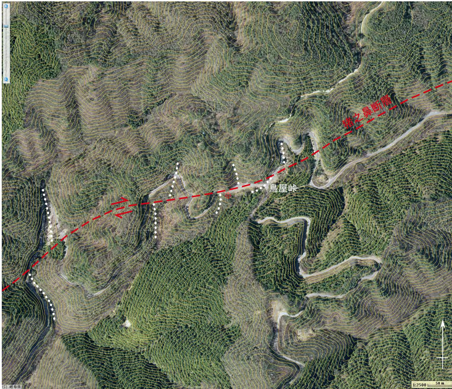
図4 鳥屋峠付近の猪之鼻断層の断層変位地形
