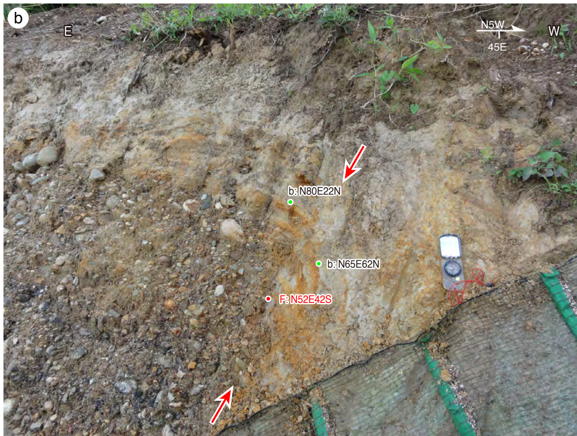
図5 a) 高岡市上向田上五位神社付近の工事現場 (図3のLoc. 1) で確認された石動断層の副次的断層 (バックスラスト) による低位段丘構成層の変形. 折れ尺の長さは1m. b) 断層近傍の拡大写真. 写真範囲を図5aに示す. 断層を赤色矢印で示す. f: 断層面, b: 層理面.
