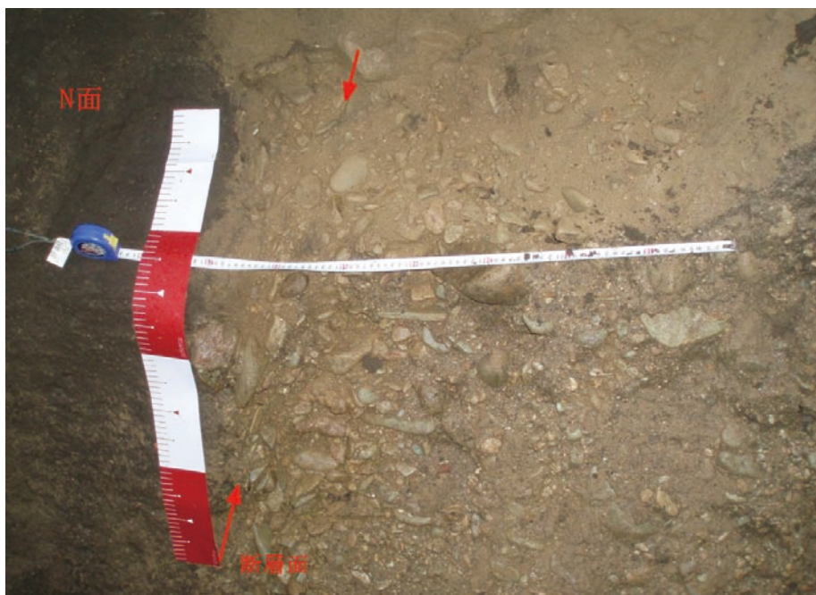
図4 中川トレンチ平面掘りスケッチ. 写真: 中川トレンチのN面から北側に水平方向に掘り込み, 上部から変形構造を観察.
