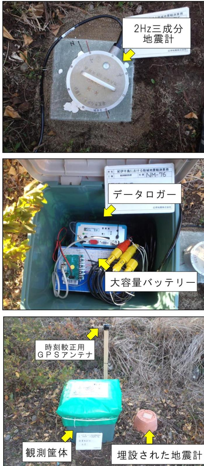
図 25 地震観測点の写真。(上) 観測に使用した 2Hz 三成分地震計、(中) 観測筐体の中の様子、(下) 観測点の外観。
