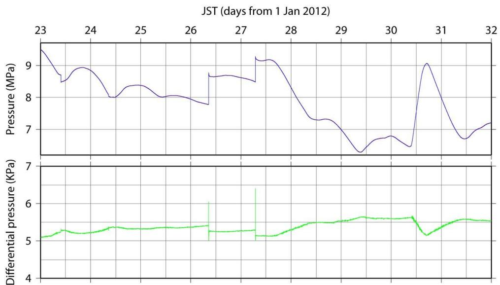
図 25 海底水圧計で使用しているのと同型の水圧センサーに対して行った圧力印加室内実験の結果。印加圧力（上）を変化させたときの、被検センサーと基準センサーの指示圧力の差（下）。
