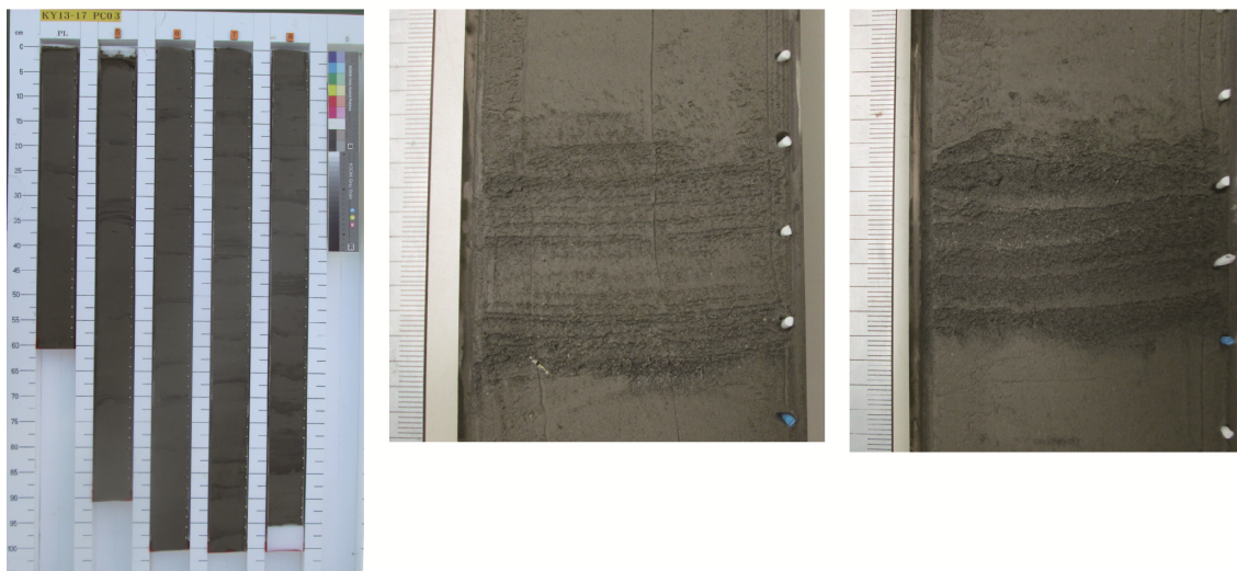
図13 室戸トラフから海底堆積物コアと挟在するタービダイト。地震・津波発生履歴の検討のため、タービダイト間の堆積物に含まれる浮遊性有孔虫の遺骸を用いて放射性炭素年代測定を実施し、タービダイトの堆積年代と堆積間隔を推定した。
