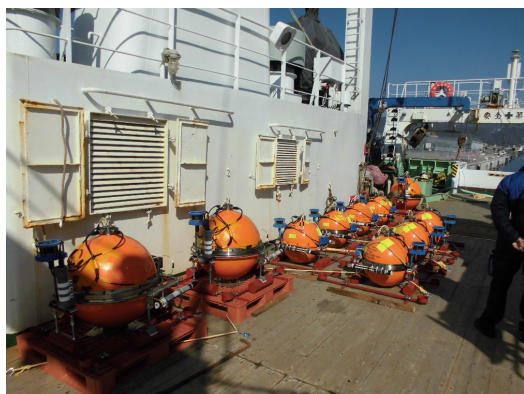
図16 設置に使用した船舶甲板にて、投入準備が完了した設置直前の長期観測型海底地震計と広帯域海底地震計。
