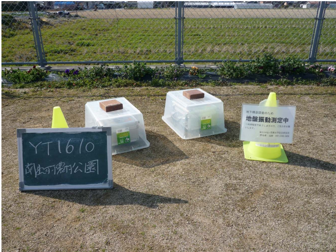
写真1 八代平野における単点微動観測実施状況 (YT1610 地点)
