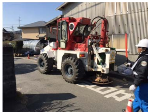
写真 1. 反射法地震探査で使用した機器。 左上：バイブレーター（人工震源） 右上：油圧インパクト（人工震源） 左下：受振器
