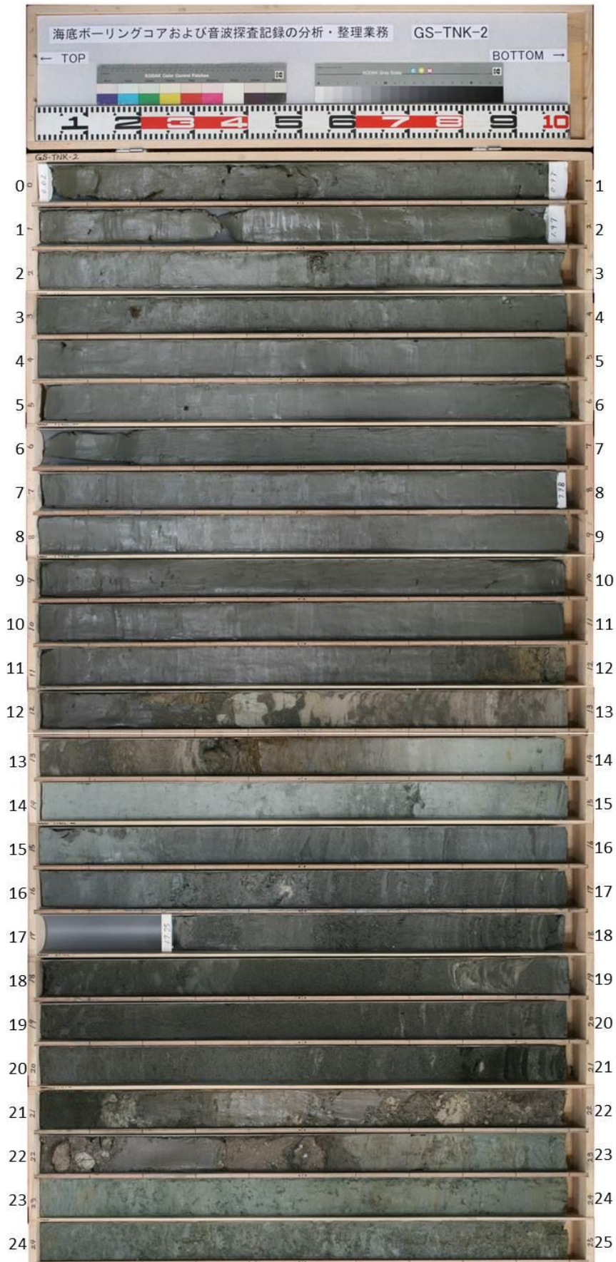
図 54 GS-TNK-2 (掘進長 25.0m、孔口標高-30.19m)
