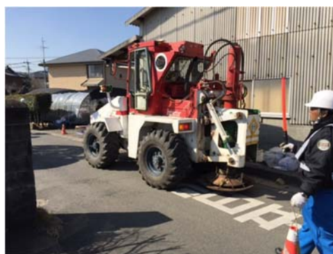
写真 1. 反射法地震探査で使用した機器。 左上：バイブレーター（人工震源） 右上：油圧インパクト（人工震源） 左下：受振器
