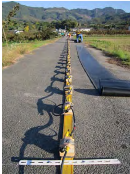
図 13a 受振器. ランドストリーマータイプのマルチチャンネル反射法探査計測ツール (受振器間隔 0.5m, 計 48 チャンネル). 観測車により牽引する.
