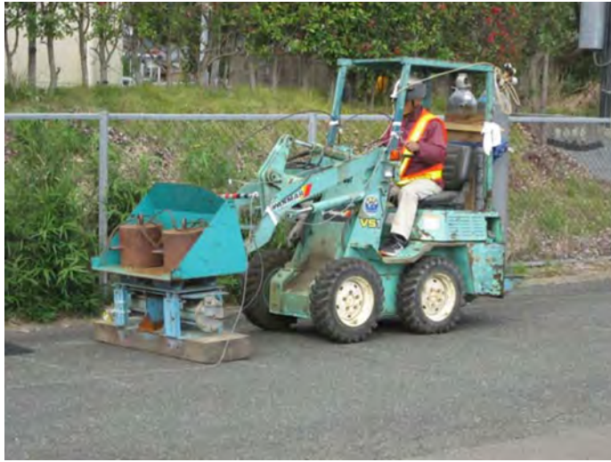
図 13b インパルス型の機械式 S 波震源（クローラーマウントタイプ）
