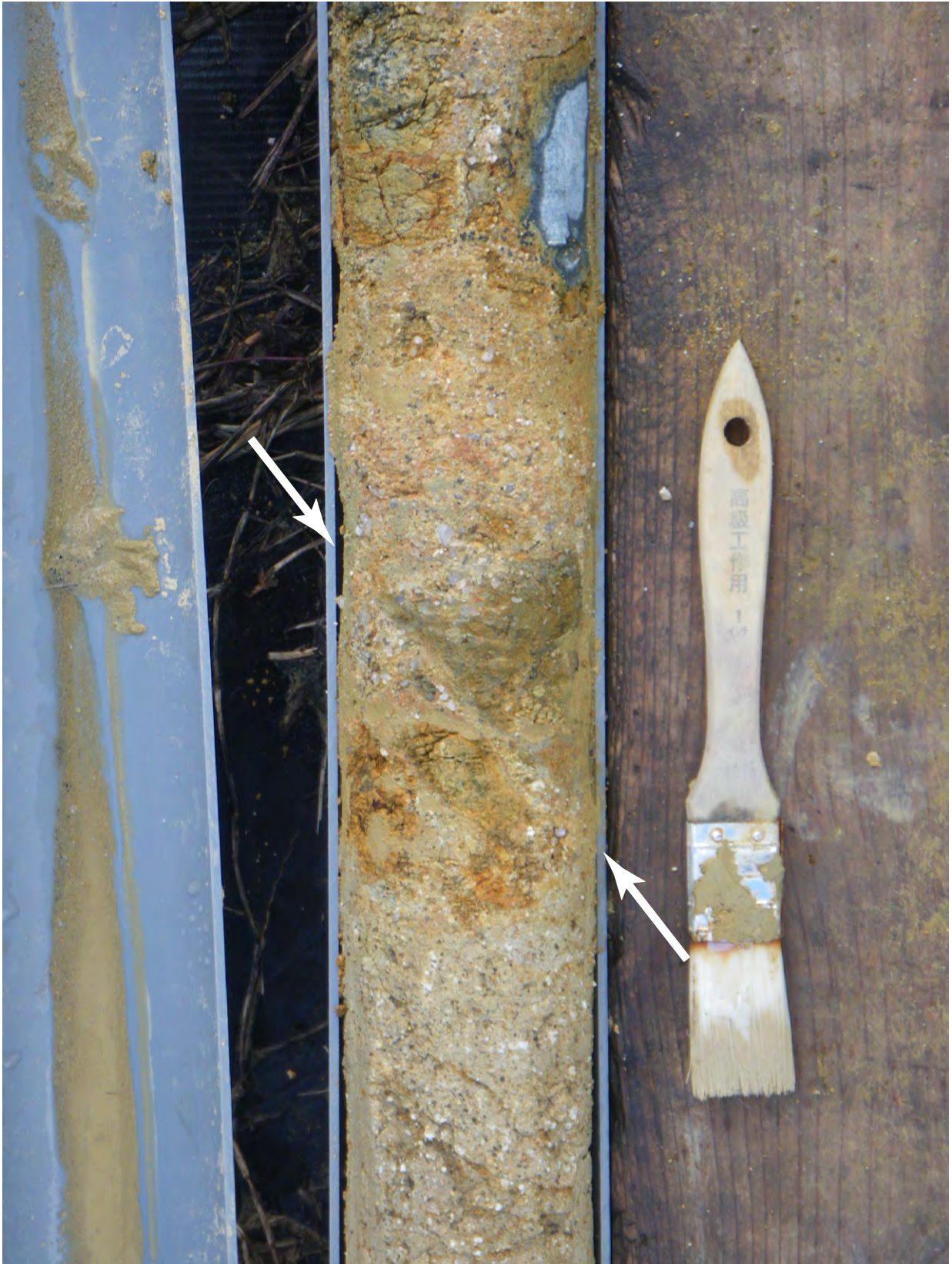
図14 堀田地点HT-4孔コアの写真 白矢印の間が断層とみられる破断面. コア径は約6cm.
