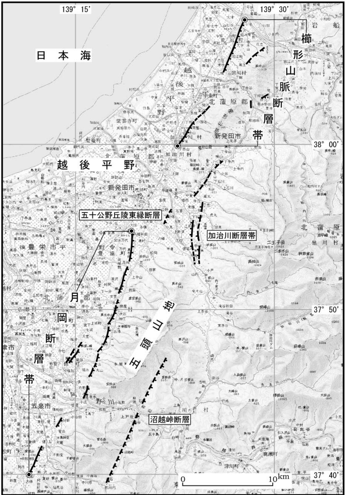
図3 櫛形山脈断層帯及び月岡断層帯とその周辺に位置する断層
